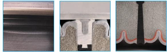
Láminas laterales TPR calor soldables (izquierda) se integran con el sistema de impermeabilización de cubierta. Fuelles de silicona Herméticos (centro) se sientan bajo la transitable placa de cubierta. Separador (derecha) sigue hacia abajo a través del revestimiento intumescente ignífugo y revestimiento exterior de silicona que bordean la parte inferior del SJS-FP-FR.
