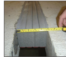
Junta en su máxima expansión. (+50% de tamaño nominal.)
