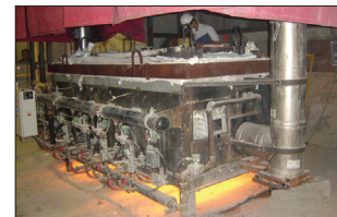
Las pruebas realizadas a Emshield DFR2 llegaron a una temperatura máxima de 1010°C.
